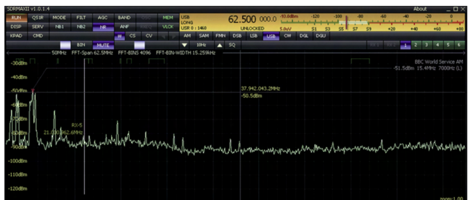
Bild 2: Der maximal darstellbare Bereich von 50 MHz, links gekennzeichnet BBC World Service auf 15,4 MHz
