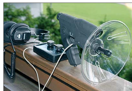
Bild 8: Ultraschallempfänger mit Parabolreflektor
