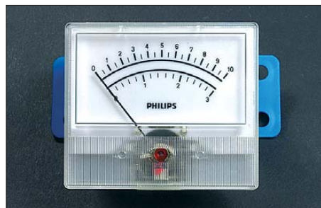
Bild 11: Zeigerinstrument aus dem EE 2014 mit Halterung zur Montage auf einer Grundplatte
