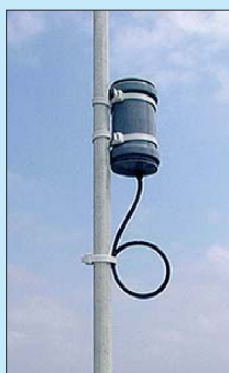
Bild 3: Mini-Aktivantenne für den Bereich von 10 kHz bis 20 MHz; Beschreibung in einer der nächsten Ausgaben
