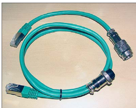
Bild 8: Ein Satz Adapterkabel für den Anschluss von Mikrofonen und Transceivern mit 8-poligen Rundbuchsen
