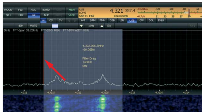
Bild 5: Alle Filter lassen sich über Schieberegler in den geöffneten Fenstern (hier unteres Fenster) einstellen; oberhalb Einstellfenster für AGC (links) und zwei Notch-Filter.
