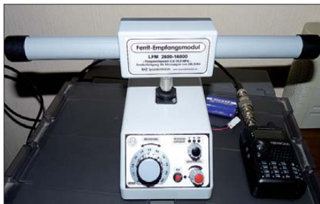
Portables BAZ-Ferritsystem mit einem TH-F7E als Empfänger Foto: DK2OM
