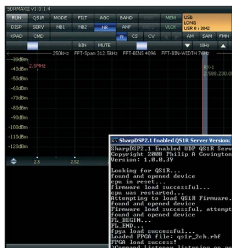
Bild 4: Die Startbildschirme, das kleinere Fenster rechts unten ist der Server, im Hintergrund das grafische Benutzerinterface GUI
