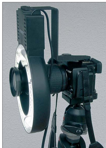
Montage der Ringfotoleuchte an einer Olympus E-330 Foto: DL2MCD
