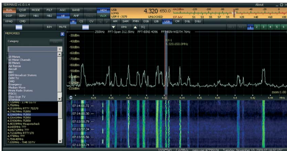
Bild 7: Links im Bild ist das Fenster für die gespeicherten Sender erkennbar. Grau hinterlegt sind die Kategorien der Einträge, um z. B. nur DRM-Sender zur Auswahl anzuzeigen.
