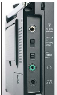
Bild 3: Der PL-600 hat eine Buchse zum Anschluss externer KW- und UKW-Antennen.
