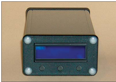
Bild 1: Musteraufbau des im Aluminiumgehäuse untergebrachten Stereo-Prüfgenerators
