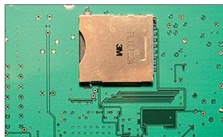
Bild 9: Der SD-Kartenslot auf der Unterseite der Platine
