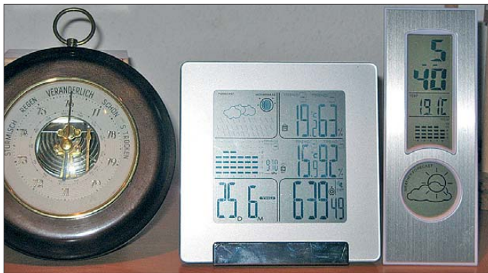
Bild 1: Die Wetterstation von [1] in der Mitte zeigt den Ortsluftdruck an (360 m ü. NN), das Barometer links den auf Meereshöhe umgerechneten Wert.
