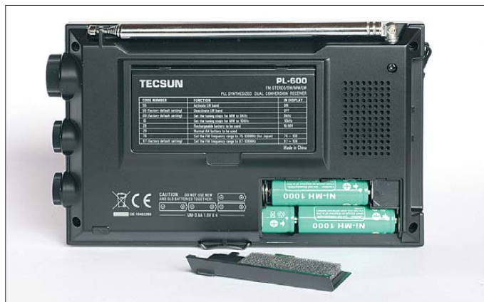
Bild 4: Zum Lieferumfang gehören Akkumulatoren, die sich im Empfänger laden lassen.
