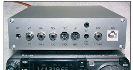
Bild 7: Die rückseitigen Anschlüsse sind eindeutig gekennzeichnet und die Gehäusedurchbrüche so gestaltet, dass gegebenenfalls auch Steckergehäuse in die Bohrungen passen.
