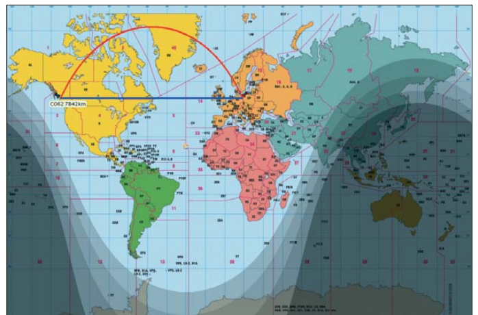
Bild 5: Orthodrome (rot) und Loxodrome (blau) auf einer Karte in Merkator-Projektion; die Orthodrome ist stets Teil eines Großkreises. Liegt sie nicht auf einem Meridian oder dem Äquator, ändert sich an jedem Bahnpunkt der Kurs. Die Loxodrome schneidet alle Meridiane im gleichen Winkel, der Kurs zum Ziel bleibt gleich.
