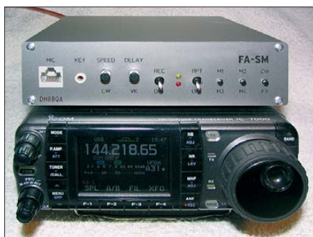
Bild 1: Das von DH8BQA aufgebaute Muster des FA-Stationsmanagers, hier auf dem IC-7000; die Gehäusegröße passt perfekt zu den Abmessungen moderner Mobiltransceiver.
