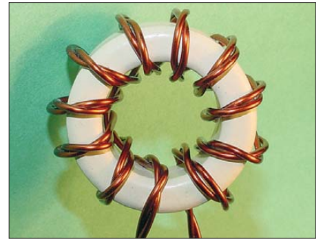
Bild 17: 1:4-Balun, 2x 10 Wdg. 1,0 CuL bifilar gewickelt
